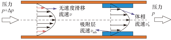
图3 干酪根有机孔内流体运移示意图
